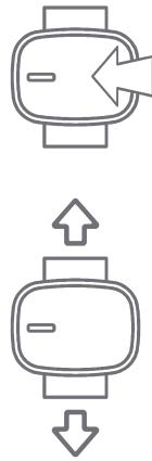
**Richtingaanwijzer:** schuif de knop naar links om de richtingaanwijzer links aan te zetten; schuif de knop naar rechts om de richtingaanwijzer rechts aan te zetten. Druk de knop in om de richtingaanwijzer uit te schakelen.
